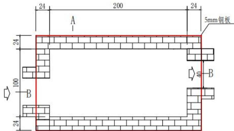
图 3.4 临时沉沙池典型设计图（单位：cm）
