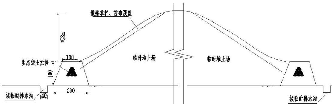
图 3.5 临时堆土场典型设计图（单位：m）
